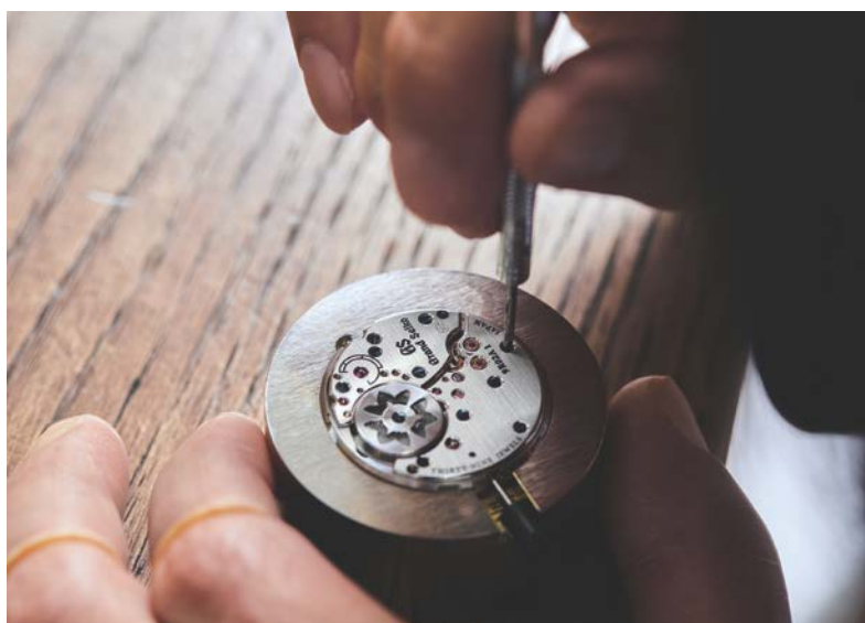
Le calibre 9R02 est minutieusement assemblé au Micro Artist Studio
